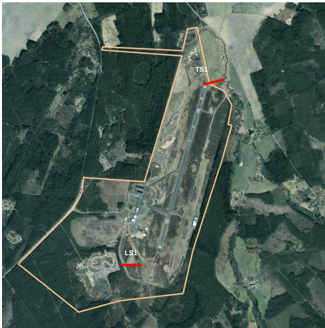
Figur 10 Översiktsbild som visar läge för utförd stabilitetsberäkning. Röd linje visar sektion där totalstabilitet ned mot Rallebäcken har beräknats.
